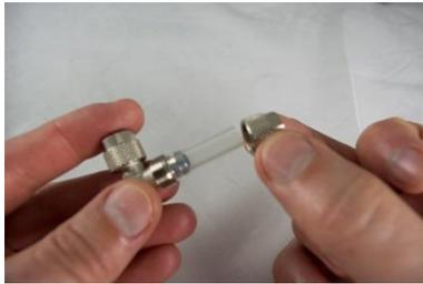
4. Schneiden Sie vom Druckluft-Schlauch (nicht im Lieferumfang enthalten) ein ca. 25mm langes Stück ab, und verbinden dieses mit dem mitgelieferten Winkelstück.
