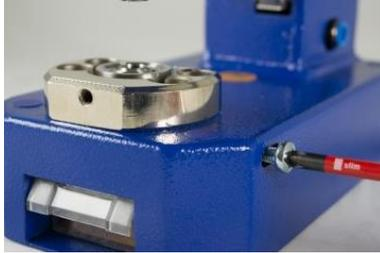
4. Lösen Sie mit einem Schraubendreher die rechte Schraube für das untere Ölwerkzeug.
