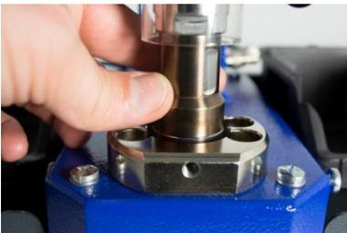
6. Bewegen Sie das obere Öswerkzeug mehrmals komplett in das untere und kontrollieren, dass das obere Öswerkzeug mittig in das untere Öswerkzeug eintaucht, ohne dass es hakt.
