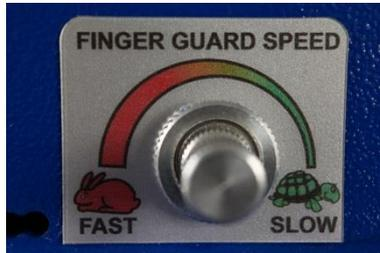
Die Geschwindigkeit, mit der sich der Fingerschutz abwärts bewegt, kann über die Einstellschraube justiert werden. Dadurch können Unterschiede in der Druckluftzufuhr ausgeglichen werden. Durch Drehen im Uhrzeigersinn wird die Geschwindigkeit verringert. Diese Einstellung hat nur Einfluss auf die Benutzung des Fußpedals.
