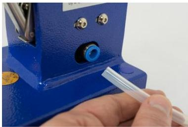
1. Entfernen Sie den Druckluftschlauch.
