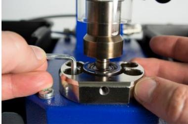
11. Ziehen Sie die beiden vorderen Schrauben an der unteren Halterung fest.
