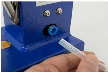
1. Entfernen Sie den Druckluftschlauch.
