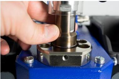
12. Bewegen Sie das obere Öswerkzeug mehrmals komplett in das untere und kontrollieren, dass das obere Öswerkzeug mittig in das untere Öswerkzeug eintaucht, ohne dass es hakt.
