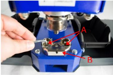
4. Wenn nötig, lösen Sie die beiden Inbusschrauben A, und bewegen die untere Halterung B zusammen mit dem Öswerkzeug in die Richtige Position.
