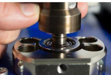
3. Überprüfen Sie die Position des oberen zum unteren Öswerkzeugs. Beide müssen exakt mittig übereinander stehen, und das obere Öswerkzeug muß ohne zu haken in das untere Werkzeug eintauchen.
