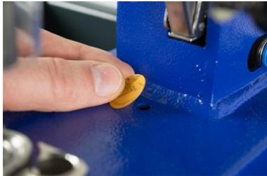
1. Entfernen Sie den gelben Aufkleber, sowie das obere und untere Öswerkzeug.
