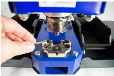
9. Lösen Sie die beiden vorderen Schrauben an der unteren Halterung.
