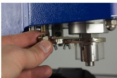
2. Entfernen Sie die Mutter an der hinteren linken Schraube.
