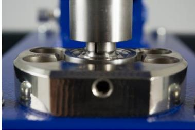
5. Ziehen Sie die beiden Inbusschrauben fest, bewegen das obere Öswerkzeug auf und ab und kontrollieren noch einmal die korrekte Position.
