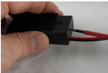
2. Gehen Sie dann mit einem flachen Schraubendreher in den Spalt, und drehen den Schraubendreher vorsichtig.
