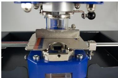
3. Platzieren Sie den Abstandshalter so, dass die Stifte A,B und C in die entsprechenden Löcher A,B und C passen. Drücken Sie den Abstandshalter ganz nach unten.
