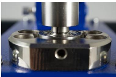
3. Überprüfen Sie die Position des oberen zum unteren Öswerkzeugs. Beide müssen exakt mittig übereinander stehen.
