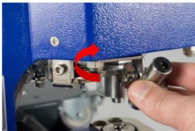
5. Zum Justieren nach vorn und hinten drehen Sie die Halterung in der horizontalen Ebene.
