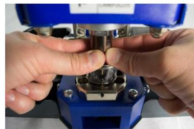
10. Ziehen Sie das obere Öswerkzeug mit den Fingern nach unten und bewegen die untere Halterung so, dass das obere Öswerkzeug ohne zu haken in das Loch des unteren Werkzeugs eintaucht.
