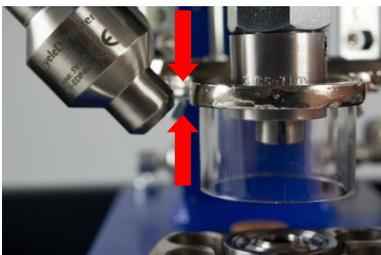
7. Überprüfen Sie, dass das obere Öswerkzeug nicht gegen den LED Pointer stoßen kann. Bewegen Sie dazu den Hand-Auslösehebel nach unten.
