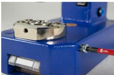
4. Lösen Sie mit einem Schraubendreher die rechte Schraube für das untere Öswerkzeug.
