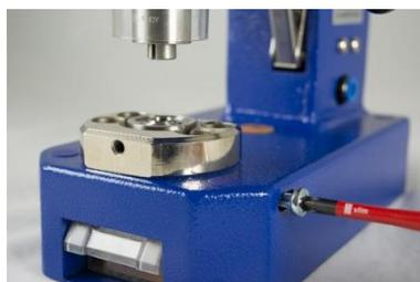
8. Ziehen Sie die Schraube für das untere Öswerkzeug fest, und überprüfen anschließend die Justage, wie im Abschnitt 5.1 beschrieben.
