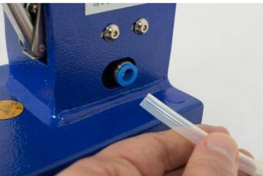
1. Entfernen Sie den Druckluftschlauch.
