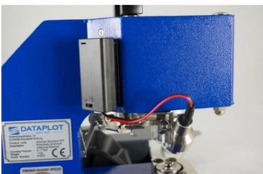
8. Verbinden Sie das Netzteil mit dem Pointer oder kleben das Batteriefach an eine geeignete Stelle, und verbinden dieses.
