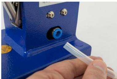
1. Entfernen Sie den Druckluftschlauch.
