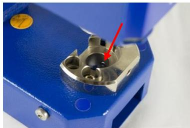
6. Die Schraube muß soweit herausgedreht werden, bis sie im Loch nicht mehr zu sehen ist.
