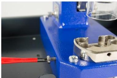
2. Entfernen Sie die linke Schraube.
