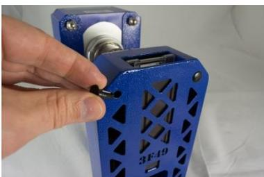
2. Entfernen Sie die 4 Plastik Füße an der Unterseite.
