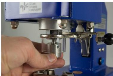
3. Bewegen Sie den Fingerschutz nach oben, und drehen Sie das obere Öswerkzeug komplett heraus.
