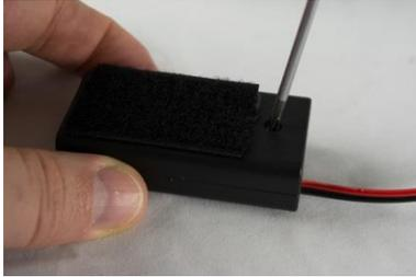
1. Um die Batterien im Batteriefach zu wechseln, entfernen Sie die Sicherungsschraube.
