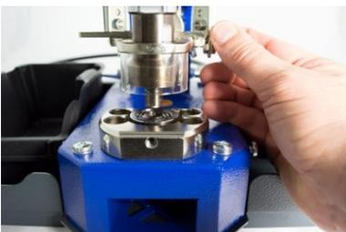
8. Bewegen Sie den Fingerschutz mit dem Hand-Auslösehebel langsam nach unten und kontrollieren, dass das obere Öswerkzeug mittig in das untere Öswerkzeug eintaucht, ohne dass es hakt. Sollte dies nicht der Fall sein, justieren Sie bitte das Öswerkzeug, wie in Abschnitt 5.1 beschrieben.
