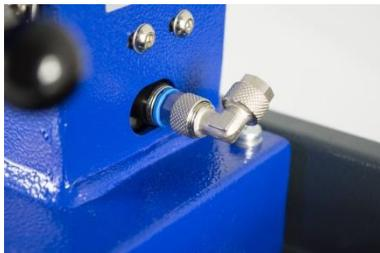
5. Stecken Sie das andere Ende des 25mm langen Schlauchs in den Anschluss am Gerät.
