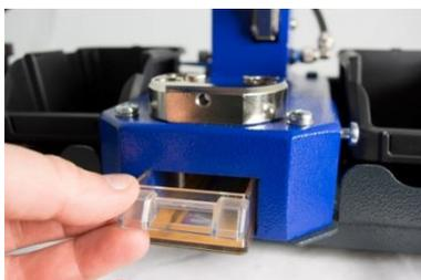
4. Entfernen Sie den Stanz-Abfallbehälter und drücken das untere Werkzeug mit dem Finger nach oben heraus.
