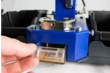
5. Entfernen Sie den Stanz-Abfallbehälter und drücken das untere Werkzeug mit dem Finger nach oben heraus.
