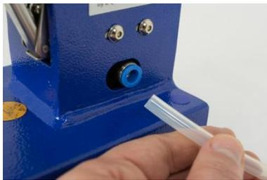
1. Entfernen Sie den Druckluftschlauch.
