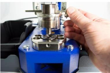
14. Bewegen Sie den Fingerschutz mit dem Hand-Auslösehebel langsam nach unten und kontrollieren, dass das obere Öswerkzeug mittig in das untere Öswerkzeug eintaucht, ohne dass es hakt. Sollte dies nicht der Fall sein, justieren Sie bitte das Öswerkzeug, wie in Abschnitt 5.1 beschrieben.
