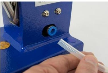
7. Schließen Sie den Druckluftschlauch an.
