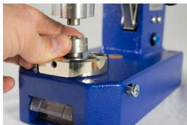
7. Führen Sie das untere Öswerkzeug in das Loch ein und drücken es bis zum Anschlag.
