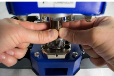
2. Bewegen Sie den Fingerschutz mit dem Hand-Auslösehebel nach unten. Ziehen Sie dann mit der anderen Hand das obere Öswerkzeug nach unten.
