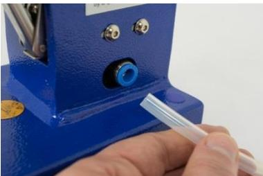
13. Schließen Sie den Druckluftschlauch an.
