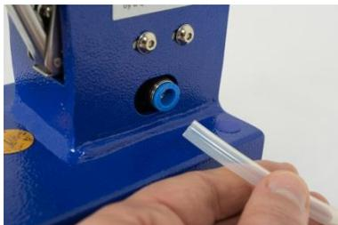
1. Entfernen Sie den Druckluftschlauch.
