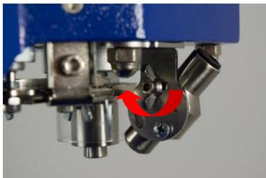
6. Zum Justieren nach links und rechts drehen Sie den Pointer. Die Kreuzschlitzschraube ist der Drehpunkt, unter der Flügelschraube ist ein Langloch zum Verändern der Position.
