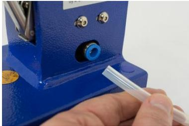
1. Entfernen Sie den Druckluftschlauch.
