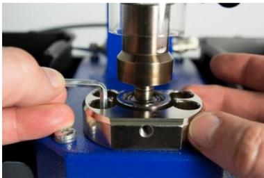
5. Ziehen Sie die beiden vorderen Schrauben an der unteren Halterung fest.
