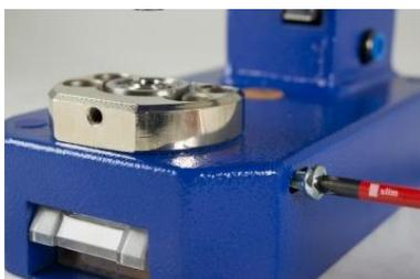
3. Lösen Sie mit einem Schraubendreher die rechte Schraube für das untere Öswerkzeug.
