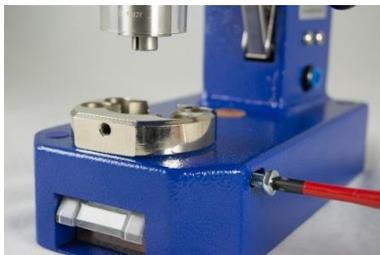
5. Lösen Sie mit einem Schraubendreher die rechte Schraube für das untere Öswerkzeug.
